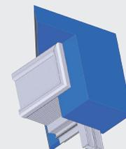
Dans le cadre d'une pose déportée, les côtés sont fermés au moyen de la planche isolée de 10 mm.
